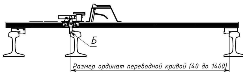
Рисунок В.3 – Схема измерения размера ординаты переходной кривой
