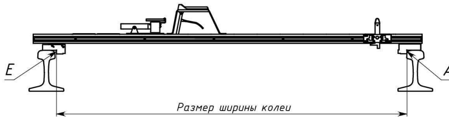
Рисунок В.1– Схема измерения ширины колеи
