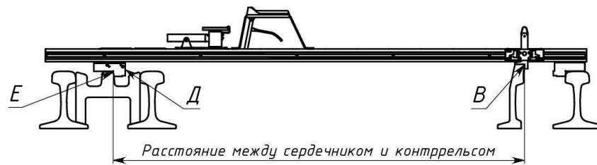
Рисунок В.2 – Схема измерения расстояния между рабочими гранями сердечника и контррельса и расстояния между рабочими гранями усовика и контррельса
